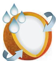
La humedad penetra en el encapsulado y disuelve el núcleo de nutriente
