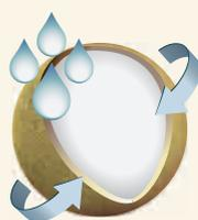
Bajo la influencia de la temperatura del suelo, la humedad penetra el encapsulado semipermeable E-Max y disuelve el núcleo de nutriente
